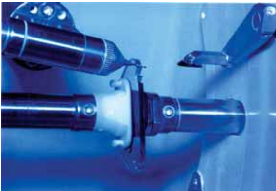
Διαμόρφωση φακού με τη χρήση εργαλείου διάτρησης καρβιδίου.
