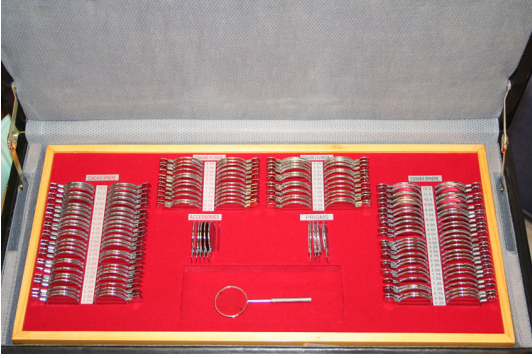
Βαλίτσα δοκιμαστικών φακών με μεταλλικό περίβλημα διαμέτρου, 103 τεμαχίων. Σε δερμάτινη θήκη. μεγάλης
